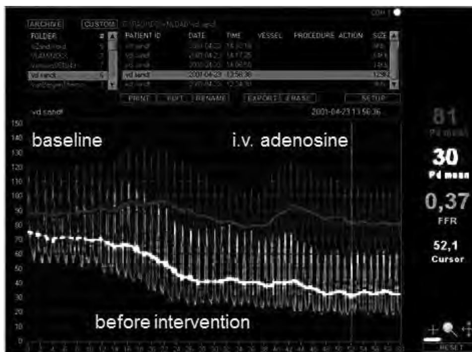
Figura 3 - In questo paziente, dopo somministrazione di adenosina, l'FFR si riduce drasticamente dimostrando la reale criticità della stenosi (pgc St. Jude Medical Inc.).
